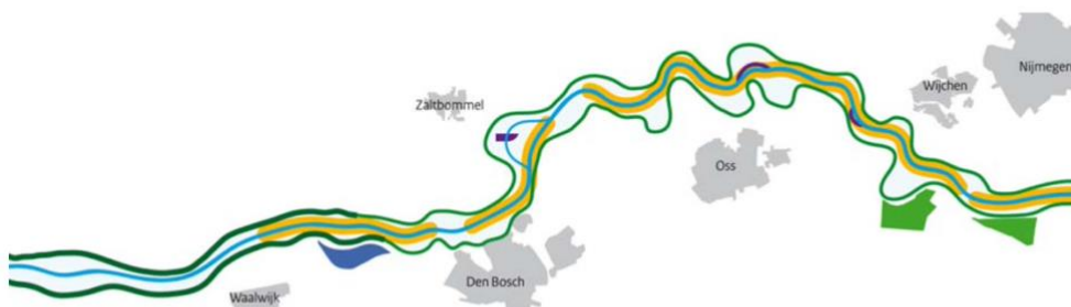
Figuur: Schematische weergave van de potentiële voorkeurstrategie In oranje de uiterwaardverlagings en een nevengeul. In groen de dijkophoging van 30 cm (excl. de kwetsbare trajecten). Rechts in de figuur de 2 retentiegebieden. Links in de figuur zomerbedverbreding, aanvullende dijkverhoging en dijkverlegging bij Bokhoven. In paars de drie locaties voor aanvullende keuzen.
